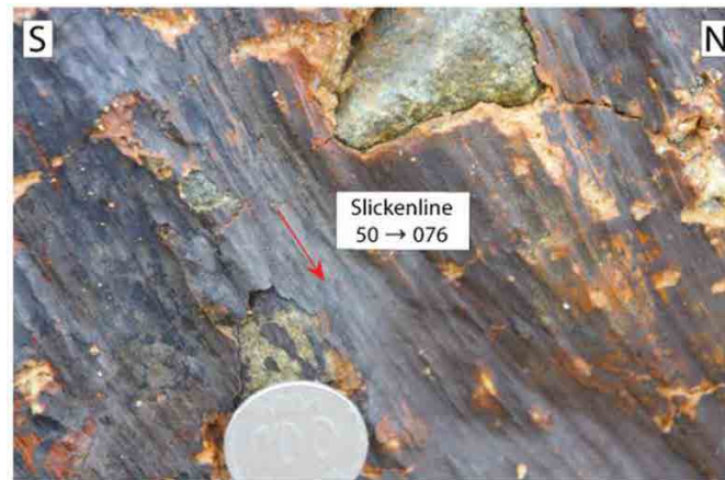
c. T-22 트렌치 굴착저면에서 확인되는 NS단층활면의 선구조
