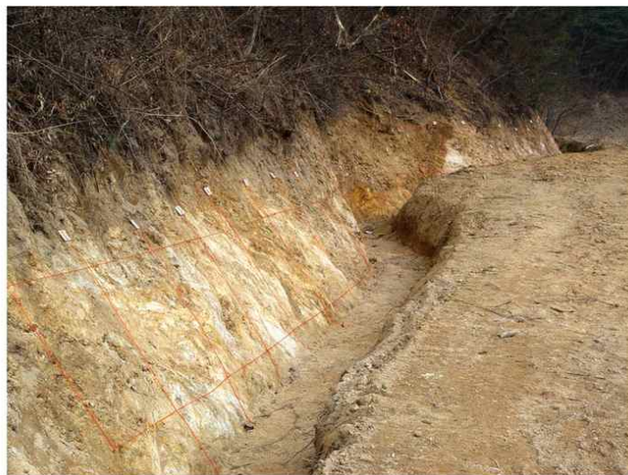
b. F225단층 및 F224단층의 연장성 확인을 위한 북측 트렌치(T-3) 단면
