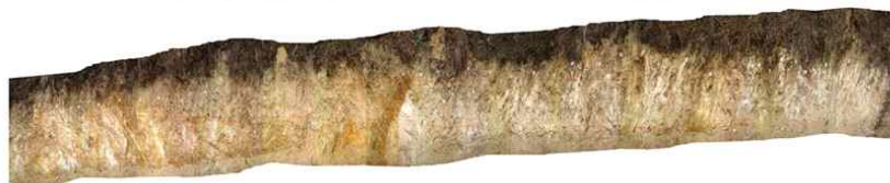
c. F225단층 및 F224단층의 연장성 확인을 위한 남측 트렌치(T-4) 단면
