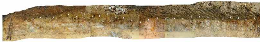
b. F225단층 및 F224단층의 연장성 확인을 위한 북측 트렌치(T-3) 단면
