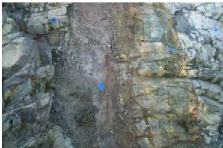
그림 4.2.2.2-10 2호기 보조건물 AB2-04 지역에 분포하는 관입암맥(SW→NE)
