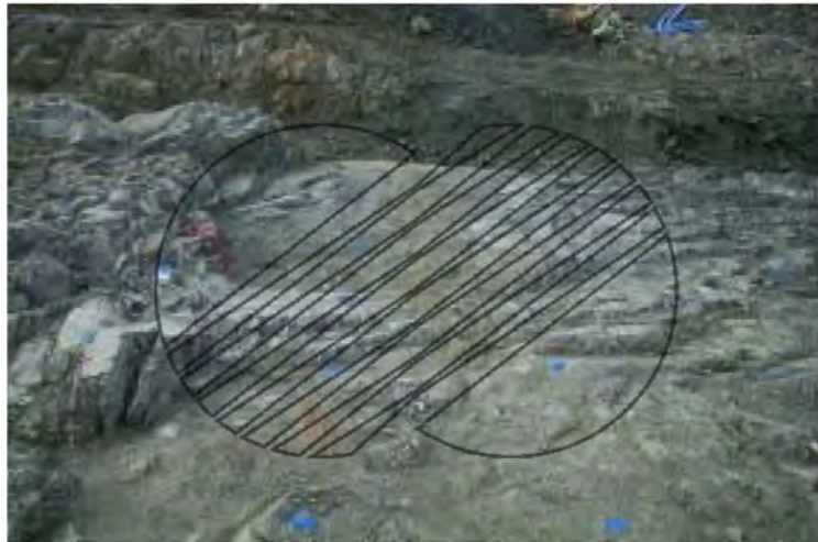
그림 4.2.3.1-27 복합건물 CPB-11 지역의 저경사 연약대 및 절리 조밀 지역(S→N)
