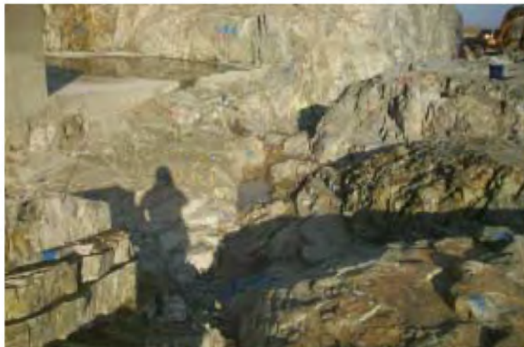
그림 4.2.2.2-13 2호기 보조건물 AB2-02 지역내 NE-SW 방향 소규모 연약대 주변부의 절리조밀 지역(SW→NE)
