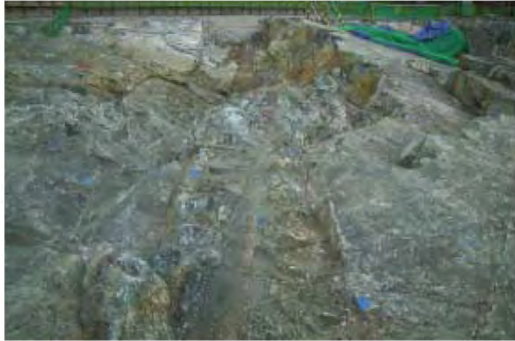
그림 4.2.2.2-11 2호기 보조건물 AB2-09 지역에 분포하는 관입암맥(NE→SW)
