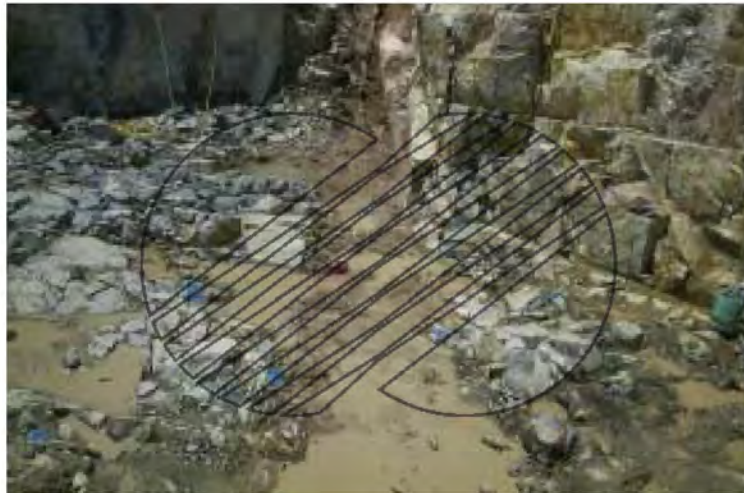
그림 4.2.3.1-21 복합건물 CPB-05-03 (남측 Sump) 지역의 연약대(N→S)
