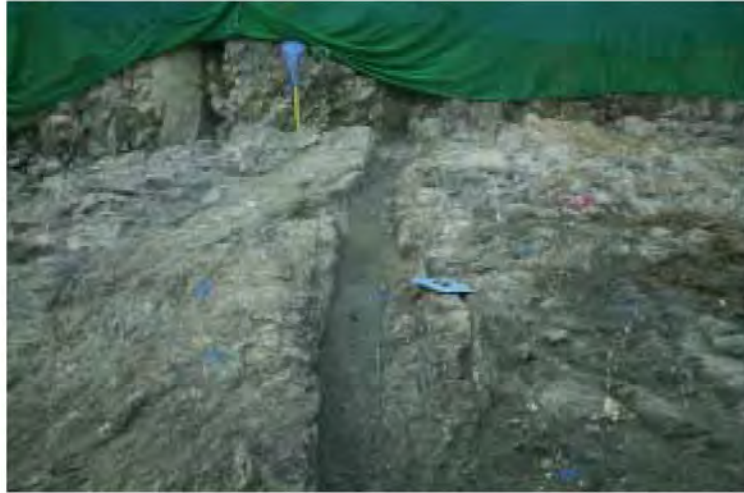
그림 4.2.2.5-16 2호기 터빈건물 TGB2-01 지역에 분포하는 관입암맥 및 관입암맥 내 연약대(N→S)
