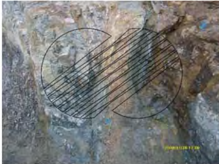
그림 4.2.1.6-5. 1호기 기기냉각수 열교환기건물 지역에 발달하는 북북동-남남서 방향의 연약대(S→N)
